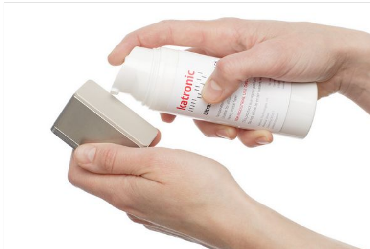
Abb. 9: Auftragen der Ultraschallkoppelpaste auf den Sensorkopf
