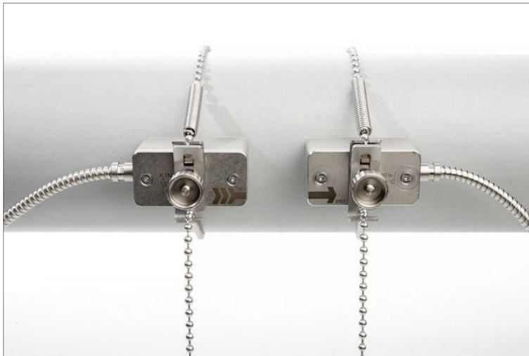
Illustration 10 : Positionnement correct des capteurs
