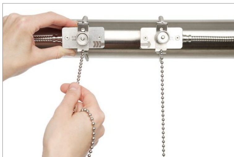
Illustration 11 : Installation des capteurs à l'aide de clips et de chaînes
