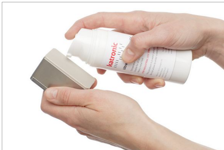
Abb. 7: Auftragen der Ultraschallkoppelpaste auf den Sensorkopf
