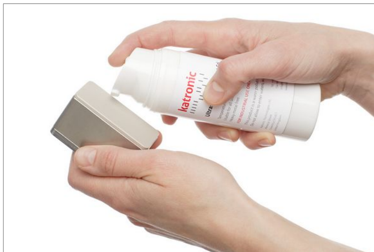
Abb. 8: Auftragen der Ultraschallkoppelpaste auf den Sensorkopf
