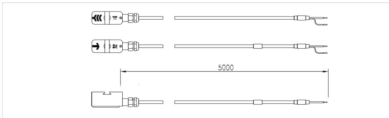
Датчики типа K4L (размеры в мм)
