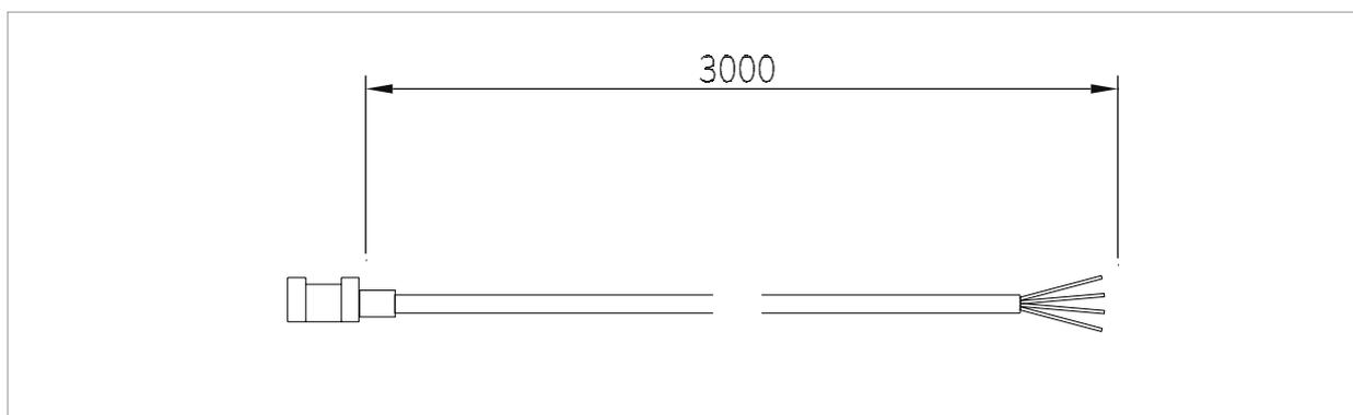
Температурный датчик типа PT100 (размеры в мм)
