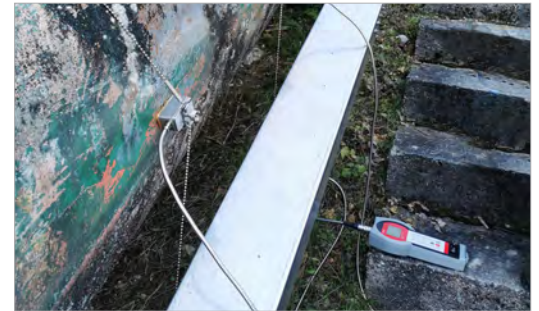
Hochgenaue Durchflussmessung in italienischem Wasserkraftwerk zur Verifizierung der Entnahmemengen.
